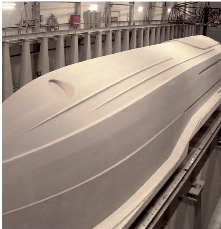
43m dlouhý trup lodi z materiálu SikaBiresin® SC175 s dokonale hladkým a bezešvým povrchem.
