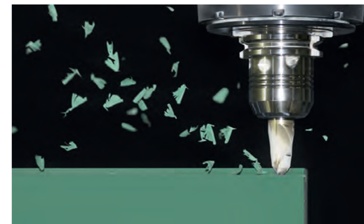
SikaBlock® M945 poskytuje vynikající chování při frézování s nízkou tvorbou prachu
