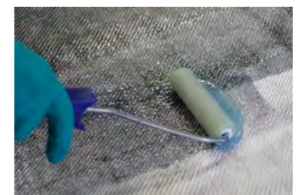
Mokré vrstvení s přípravkem SikaBiresin CR168
