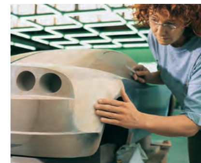
Modely frézované ze SikaBlocku® PROLAB 65 N splňují nejvyšší nároky na kvalitu povrchu.
