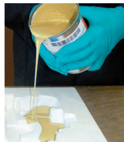
SikaBiresin® F160 s přídatnými plnivými pro odlévání modelů se silnějšími průřezy
