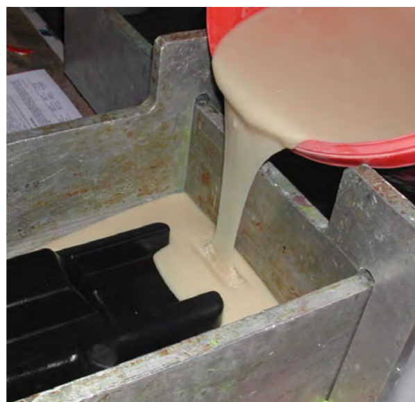
SikaBiresin® F46 připravený k použití. Oba plnitelné systémy F48 nebo F50 jsou pomalé systémy umožňující ruční odlévání velmi velkých rozměrů negativů, vzorů nebo forem s minimální smršťovací m.
