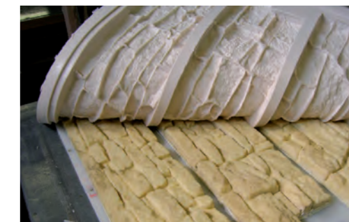
Uvolnění měkké formy SikaBiresin® UR548 pro kamenné obklady
