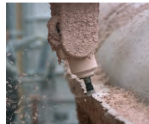
Pastu Biresin® M72 lze snadno frézovat s nízkou tvorbou prachu.
