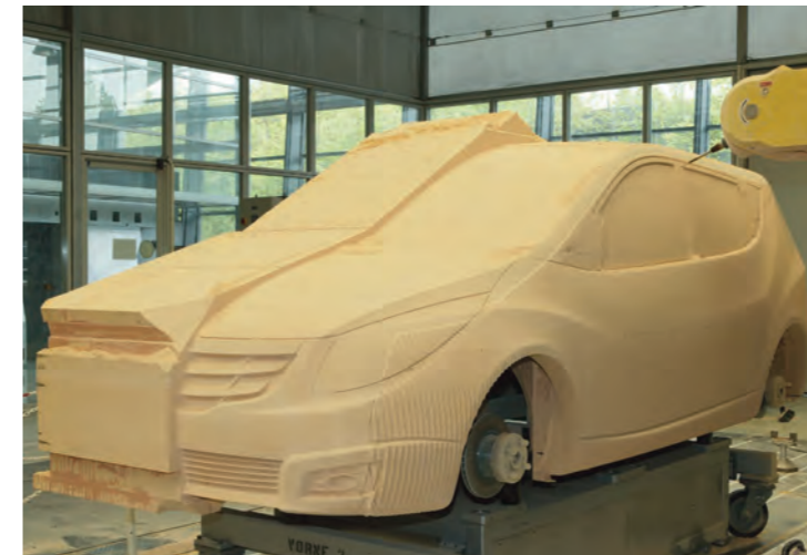
Model auta v plném měřítku z desek SikaBlock® M330 lepených SikaBiresinem® B260
